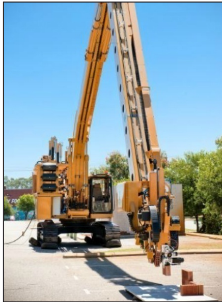
Рис. 1. Зовнішній вигляд промислових роботів компанії FBR: робот «Hadrian» (а) [6] та робот «Hadrian X» (б) [7]
