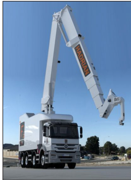
Рис. 1. Зовнішній вигляд промислових роботів компанії FBR: робот «Hadrian» (а) [6] та робот «Hadrian X» (б) [7]
