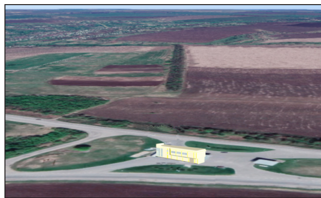
Рис. 5. Вигляд тривимірної моделі, поєднаної з ортофотознімком місцевості
